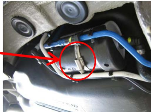
取り付けバンドの止め具の位置が不適切なもの 取り付けバンドの止め具の位置を改善したもの
